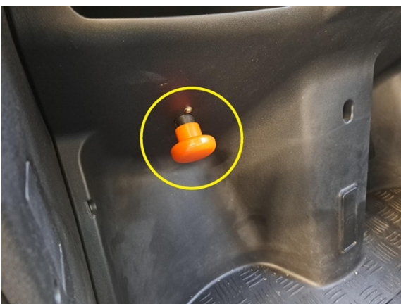
Paina päävirtakytintä kiinni.
