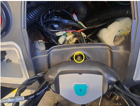
Ohjaustangon kiinnityspultin vastamutteri.
