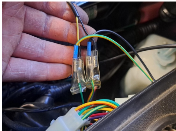
Avaa takajarrun mikrokytkimen liittimet.
