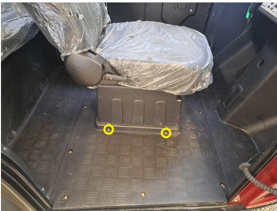
Irrota istuimen kiinnityspultit kummaltakin puolelta. (hylsy 8 mm).
