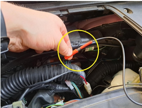
Avaa mittaristolle menevä peruutuskameran signaalijohdon liitin.
