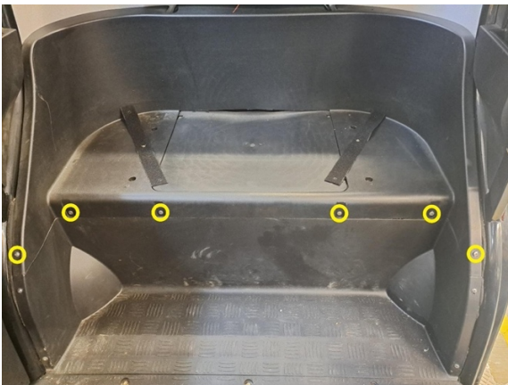
Irrota takaistuimen rungon kiinnitysruuvit. (ristipäämeisseli ph2).
