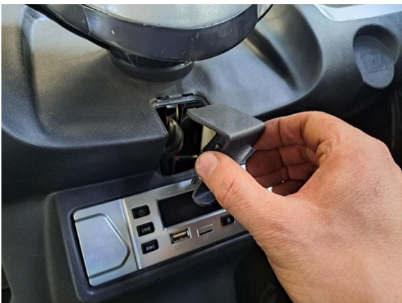
Ota ohjaustangon kiinnityspultin suojakansi pois.
