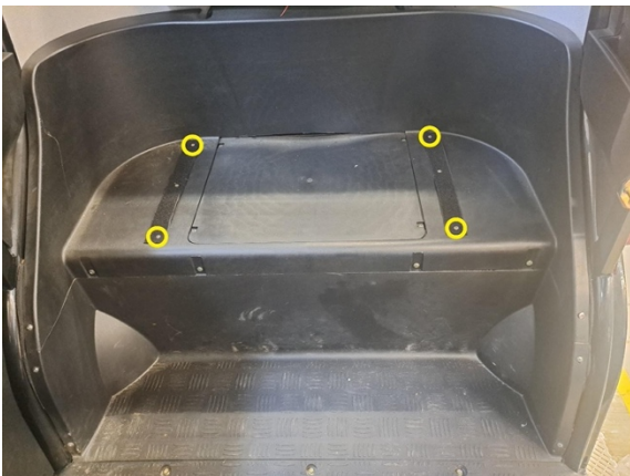
Irrota velcro tarranauhojen reunimmaiset kiinnitysruuvit. (ristipäämeisseli ph2).
