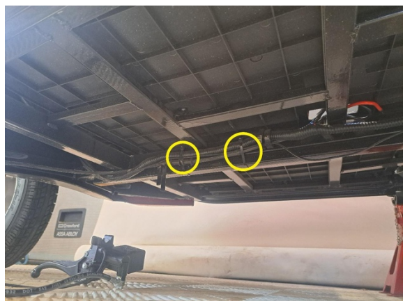
Avaa kaikki takajarruletkuja kannattelevat pidikkeet ja katko nippusiteet. (sivuleikkurit).
