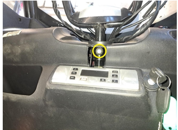
Irrota ohjaustangon kiinnityspultti, (hylsy 14 mm) jolla vastamutteri. (kiintoavain 14 mm).
