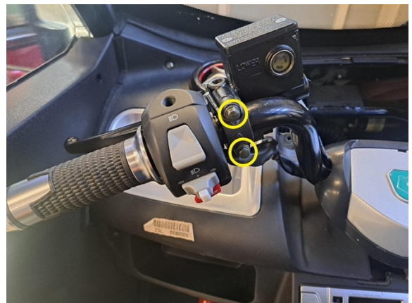
Irrota takajarrukahvan kiinnityspultti. (hylsy 8 mm).
