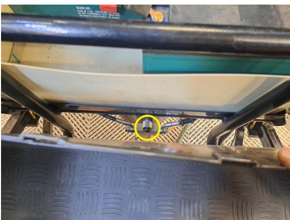
Irrota takajarru letkujen haaroituskappaleen kiinnityspultti. (hylsy 10 mm).
