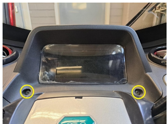
Irrota mittariston kiinnitysruuvit. (ristipäämeisseli ph2).
